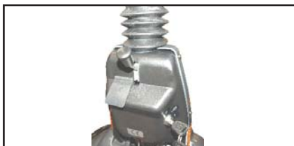
Latauspistoke liitetään ohjauspylvään kolminapaiseen latausliitäntään. Latausliitäntä on suojailevyn alla.
