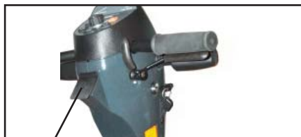
De laadstekker wordt aangesloten op een 3-polige stecker in de stuurkolom. De laadstekker zit onder de beschermplaat.
